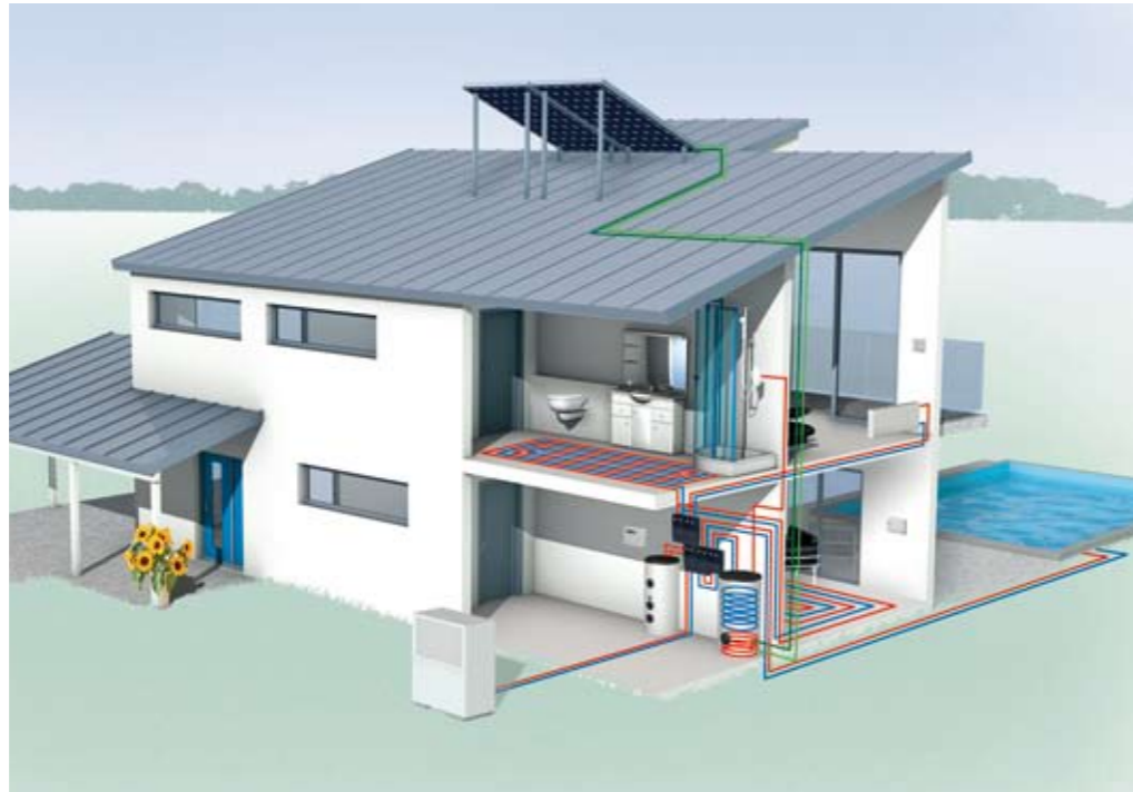
Solarkollektoren zur reinen Warmwasserbereitung über einen bivalenten Solarspeicher mit zusätzlichen Solar-Wärmetauscher in Kombination mit Luft/Wasser-Wärmepumpe.
