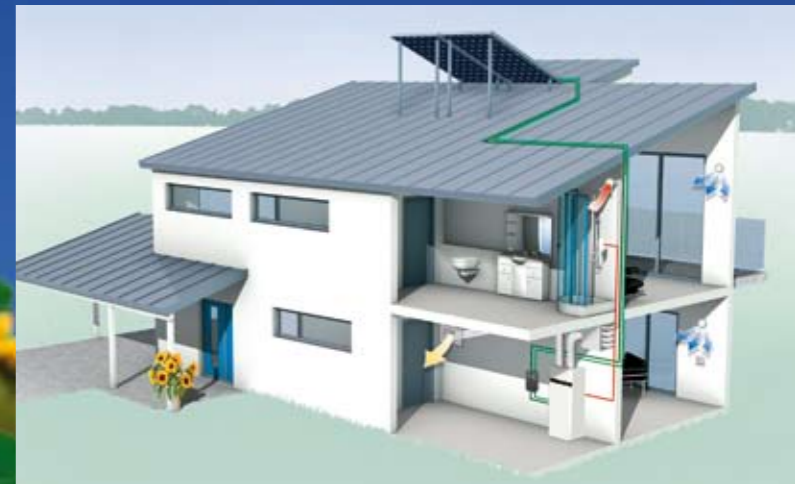
Solarkollektoren in Kombination mit Wohnungslüftungs-Kompaktgerät LWP 300 W mit integrierter Warmwasserbereitung
