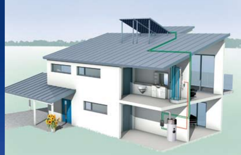
Solarkollektoren zur Warmwasserbereitung in Verbindung mit der Warmwasser-Wärmepumpe BWP 30 HLW und AWP 30 HLW
